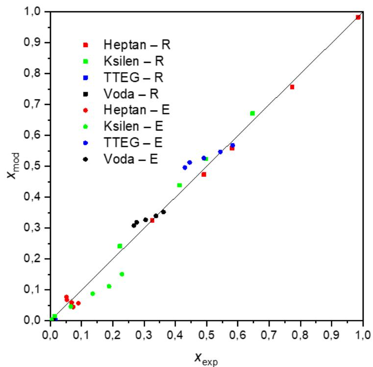
Slika 24.B. Grafički prikaz odstupanja literaturnih i modelnih sastava faza u svim eksperimentalnim točkama za sustav heptan, ksilen, TTEG i voda pri 140 °C prema Wangu, Gou i Zhuu<sup>7</sup>. Dijagonala pokazuje rasipanje točaka, tj. odstupanje eksperimenta i modela.
