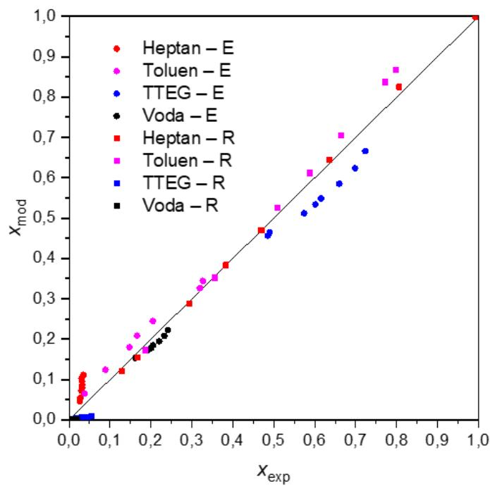
Slika 29.B. Grafički prikaz odstupanja literaturnih i modelnih sastava faza u svim eksperimentalnim točkama za sustav heptan, toluen, TTEG i voda pri 100 °C prema Wangu i suradnicima<sup>9</sup>. Dijagonala pokazuje rasipanje točaka, tj. odstupanje eksperimenta i modela.
