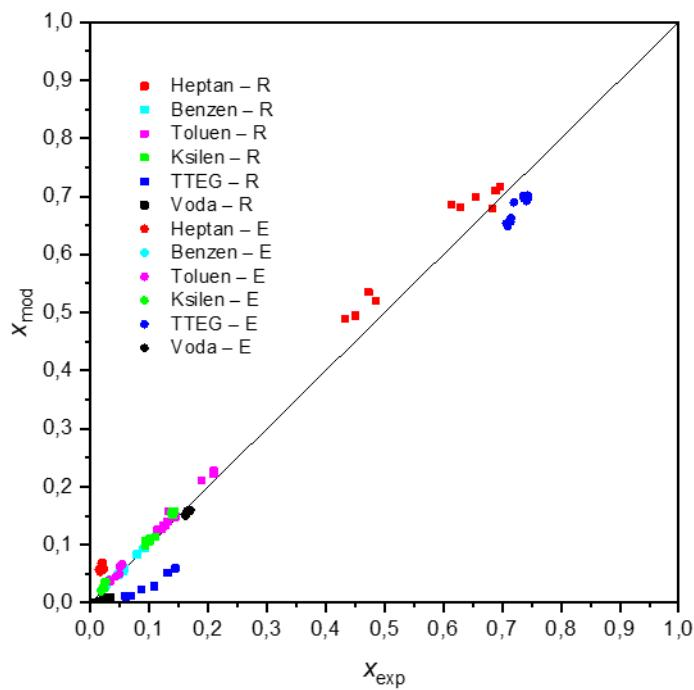
Slika 25.B. Grafički prikaz odstupanja literaturnih i modelnih sastava faza u svim eksperimentalnim točkama za sustav heptan, benzen, toluen, ksilen, TTEG i voda pri 60 °C prema Wangu, Gou i Zhuu<sup>7</sup>. Dijagonala pokazuje rasipanje točaka, tj. odstupanje eksperimenta i modela.
