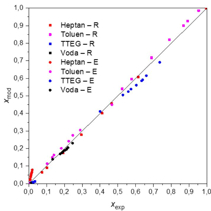
Slika 28.B. Grafički prikaz odstupanja literaturnih i modelnih sastava faza u svim eksperimentalnim točkama za sustav heptan, tolen, TTEG i voda pri 60 °C prema Wangu i suradnicima<sup>9</sup>. Dijagonala pokazuje rasipanje točaka, tj. odstupanje eksperimenta i modela.
