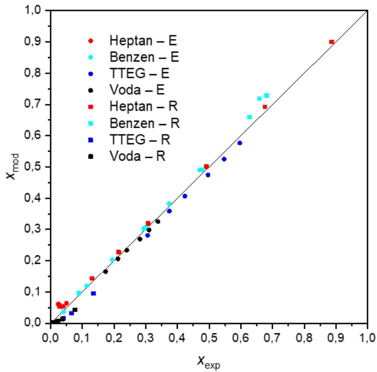
Slika 27.B. Grafički prikaz odstupanja literaturnih i modelnih sastava faza u svim eksperimentalnim točkama za sustav heptan, benzen, TTEG i voda pri 120°C prema Rawatu i Prasadu<sup>8</sup>. Dijagonala pokazuje rasipanje točaka, tj. odstupanje eksperimenta i modela.
