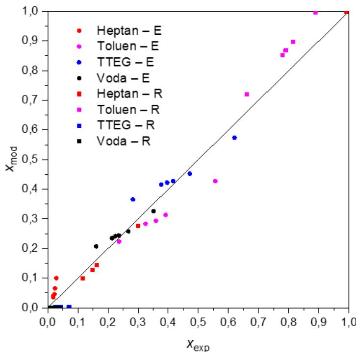
Slika 30.B. Grafički prikaz odstupanja literaturnih i modelnih sastava faza u svim eksperimentalnim točkama za drugi sustav heptan, toluen, TTEG i voda pri 100 °C prema Wangu i suradnicima<sup>9</sup>. Dijagonala pokazuje rasipanje točaka, tj. odstupanje eksperimenta i modela.
