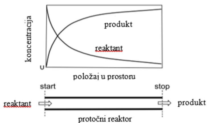
Slika 1. Profil reakcije u protočnom reaktoru<sup>12</sup>.
