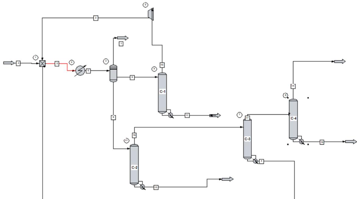
Slika 20. Base case proces rađen u CHEMCAD-u po uzoru na Petrascu et al.
