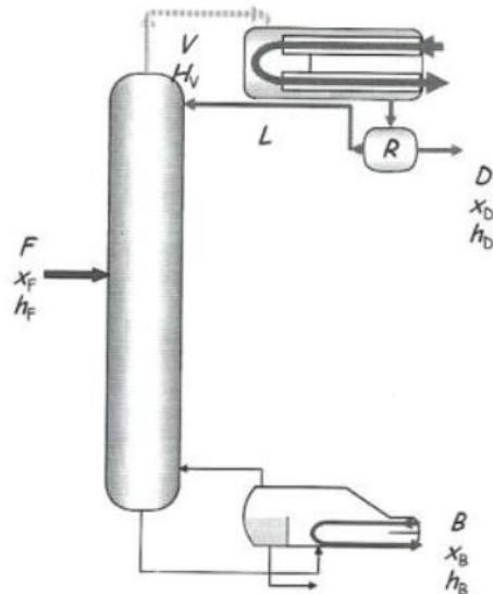
**Slika 3.** Shema destilacijske kolone za kontinuiranu destilaciju
