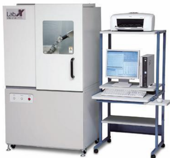
Slika 24. Difraktometar Shimadzu XRD 6000 (Shimadzu, Kyoto, Japan)
