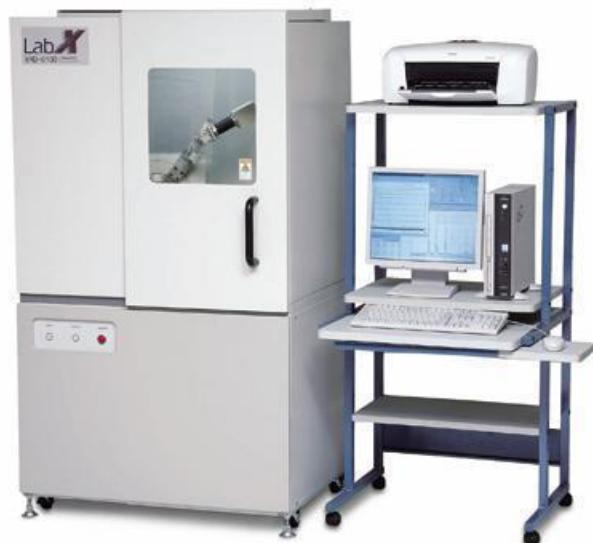
**Slika 24.** Difraktometar Shimadzu XRD 6000 (Shimadzu, Kyoto, Japan)
