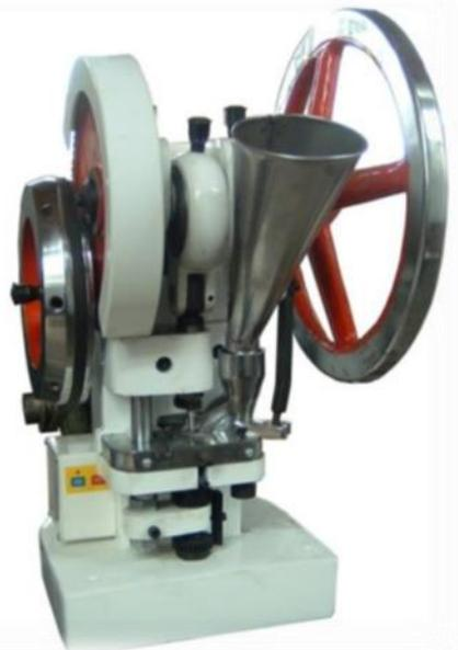
**Slika 16.** Fotografija uređaja za tabletiranje TDP-5T
