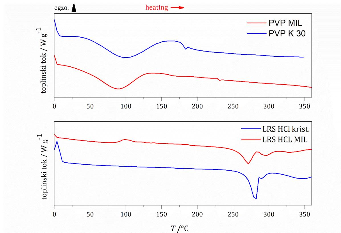
**Slika 29.** DSC termogrami ishodnog lurasideon-hidroklorida i mehanokemijski tretiranog lurasideon-hidroklorida te ishodnog i mehanokemijski tretiranog poli(vnil-pirolidona)
