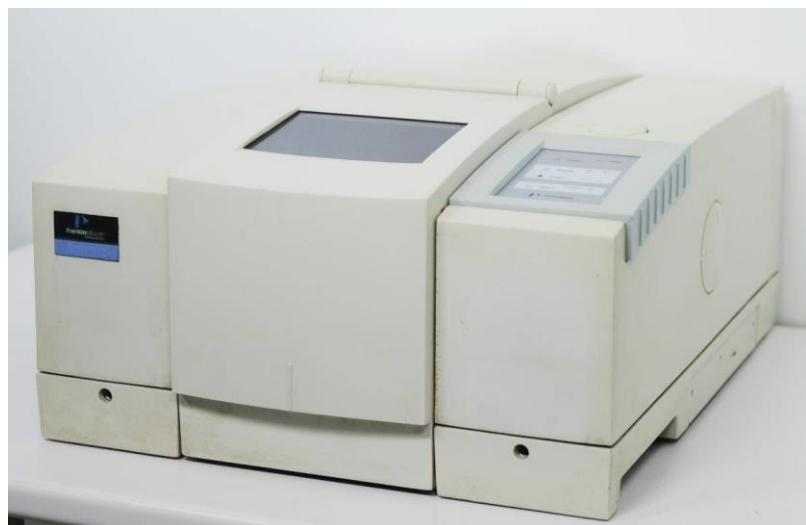
**Slika 22.** Fotografija FTIR spektrofotometra
