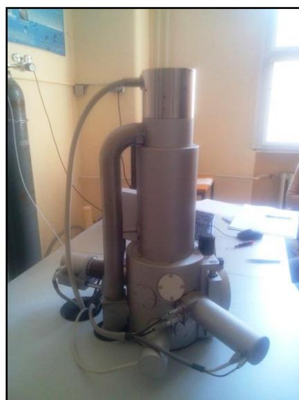
**Slika 3.7. Pretražni elektronski mikroskop SEM Tescan Vega III Easypore**
