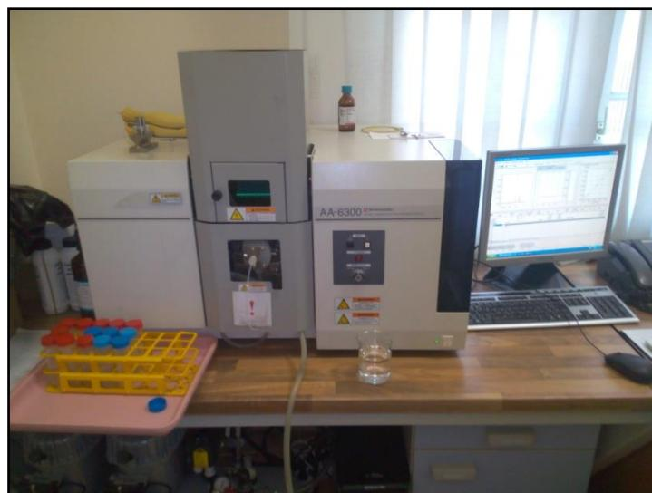
**Slika 3.5.** Atomski apsorpcijski spektrometar Shimadzu AA – 6300
