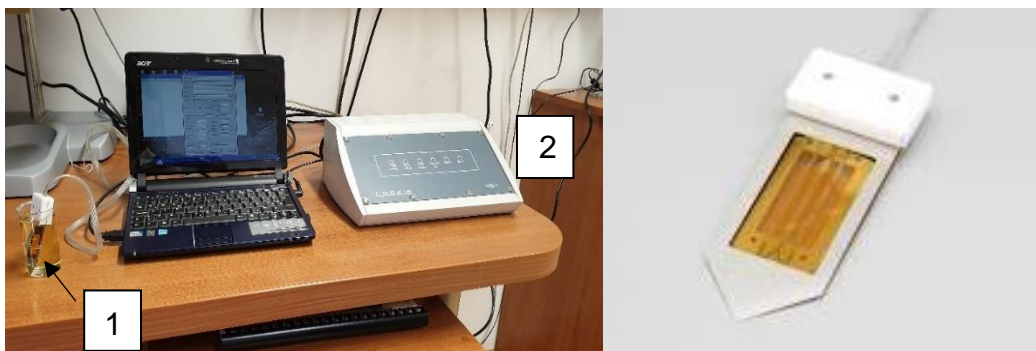
Slika 3.12. Prikaz aparature za mjerenje toplinske vodljivosti:
