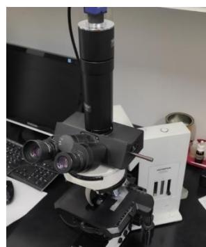
**Slika 3.6.** Svjetlosni mikroskop Olympus BX50 opremljen kamerom.
