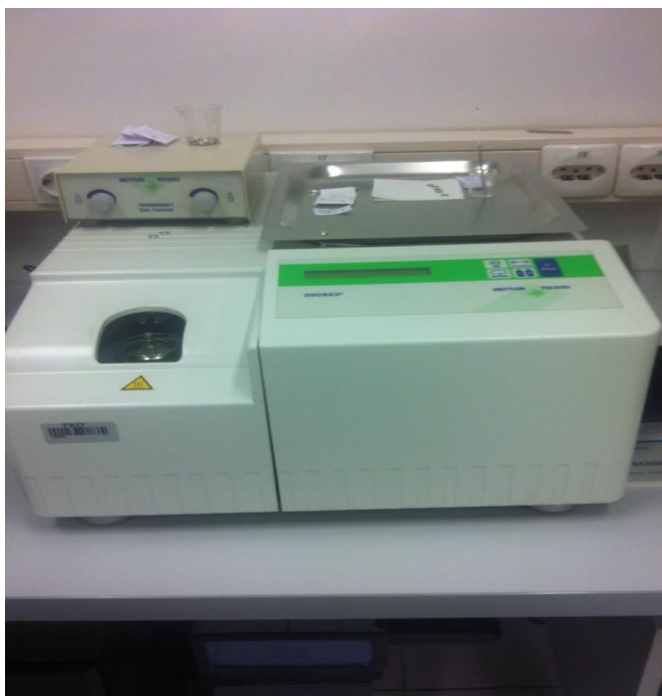
Slika 11. DSC instrument, Fakultet kemijskog inženjerstva i tehnologije.
