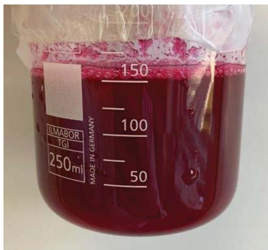
Slika 13. Prikaz zakiseljene otopine antocijanina nakon ekstrakcije i filtracije
