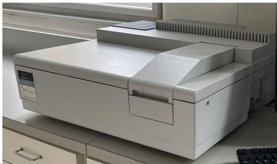
**Slika 21.** Spektrofotometar Perkin Elmer Lambda 35
