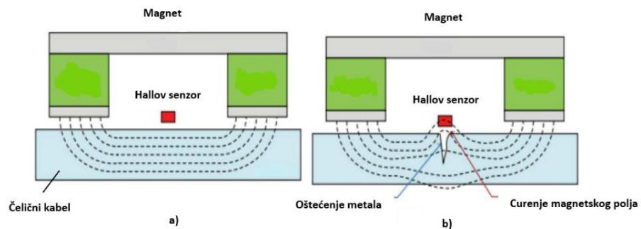
*Slika 24. Metodologija curenja magnetskog polja kod: a) neoštećenog, b) oštećenog kabela čeličnog mosta [28]*
