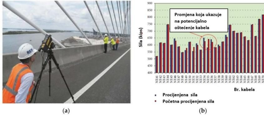
*Slika 27. a) Primjena laserskog vibrometra kod vibracijskog ispitivanja čeličnog kabela; b) graf usporedbe procijenjenih sila s očekivanim vrijednostima te detekcija oštećenja (1 kip, eng. kilo pound = 4448,2216 N) [28]*
