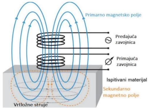
Slika 17. Princip rada metode ispitivanja vrtložnim strujama [32]
