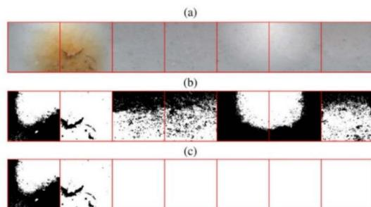
*Slika 28. a) Originalna slika uz dodatak umjetnog svjetla; b) rezultati procesuirani za 1,75 s korištenjem SKMA metode uz postotak korozije od 43,67%; c) rezultati procesuirani za 1,18 s kombinacijom RUDERM i SKMA metode uz postotak korozije od 8,63% [28]*
