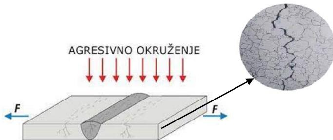
*Slika 7. Djelovanje napetosne korozije na metalnu površinu [5]*
