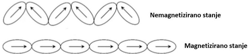
*Slika 26. Orientacija domena feromagnetičnih materijala u magnetiziranom i nemagnetiziranom stanju [39]*
