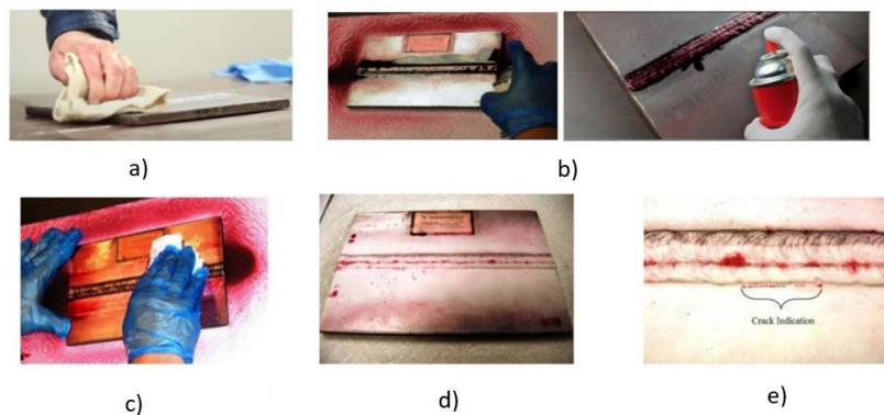
*Slika 14. Postupak provođenja penetrantskog ispitivanja: a) čišćenje i odmašćivanje ispitivane površine, b) nanošenje penetranta, c) uklanjanja penetranta, d) nanošenje razvijača, e) indikacija pukotine [28]*
