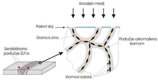
*Slika 4. Mehanizam djelovanja interkristalne korozije na nehrđajući čelik [9]*
