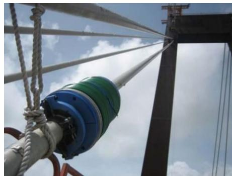
*Slika 25. Primjena metode curenja magnetskog polja na kabel čeličnog mosta [28]*
