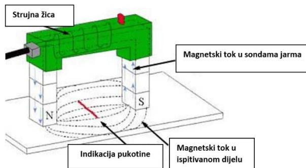
*Slika 15. Prikaz magnetskog polja nastalog primjenom magnetskog jarma [28]*
