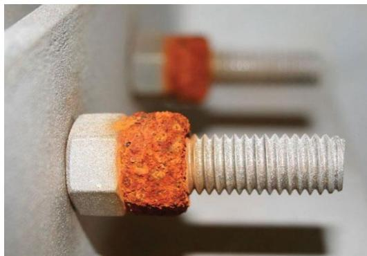
*Slika 3. Primjer galvanske korozije gdje je ne strukturna komponenta, vijak, napravljena od elektronegativnijeg materijala u odnosu na čelik s kojim je u kontaktu, te time predstavlja anodu u elektrolitskom okruženju koja pritom korodira [4]*
