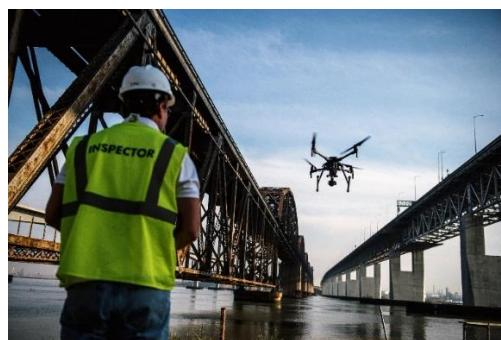
*Slika 29. Primjena dronova u inspekciji čeličnih mostova [28]*
