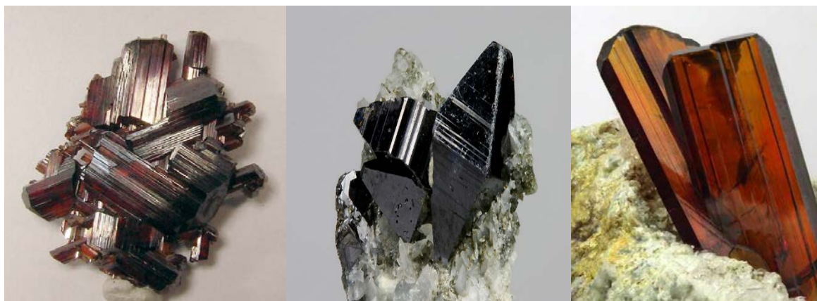
Slika 2.8. Polimorfne modifikacije \text{TiO}_2 : rutil, anatas, brukit 21,22,23
