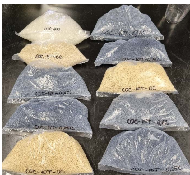
Slika 3.4. Granule ekstrudata nakon sjeckanja u granulatoru
