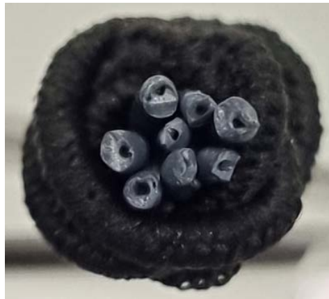
Slika 4.1. Rupe na filamentima nakon ekstrudiranja
