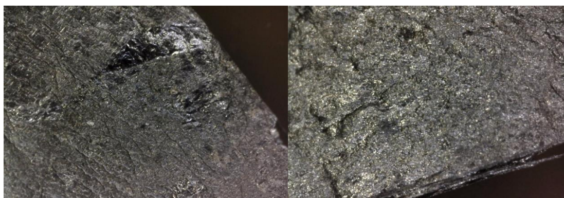
Slika 4.14. Površina rGO papira s istaloženim cinkom
