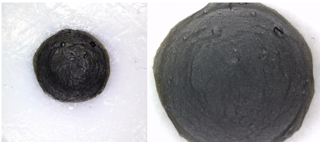
Slika 4.12. Površina GC elektrode sa slojem GO/20 % AC
