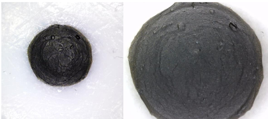
Slika 4.12. Površina GC elektrode sa slojem GO/20 % AC
