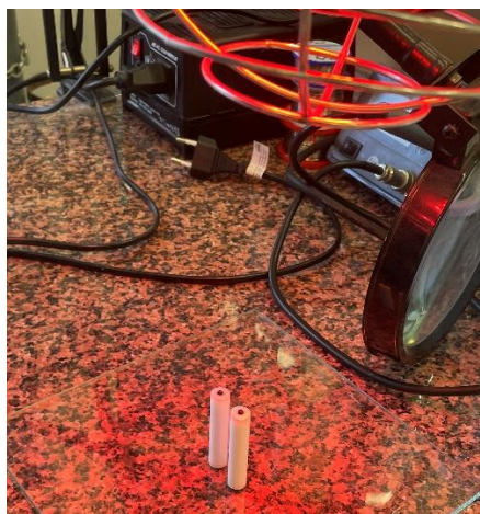
Slika 3.1. Sušenje GC/GO elektroda ispod IR lampe
