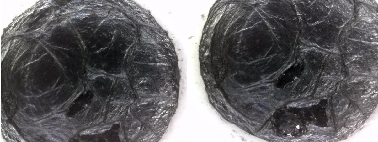
Slika 4.10. Površina GC elektrode sa slojem GO
