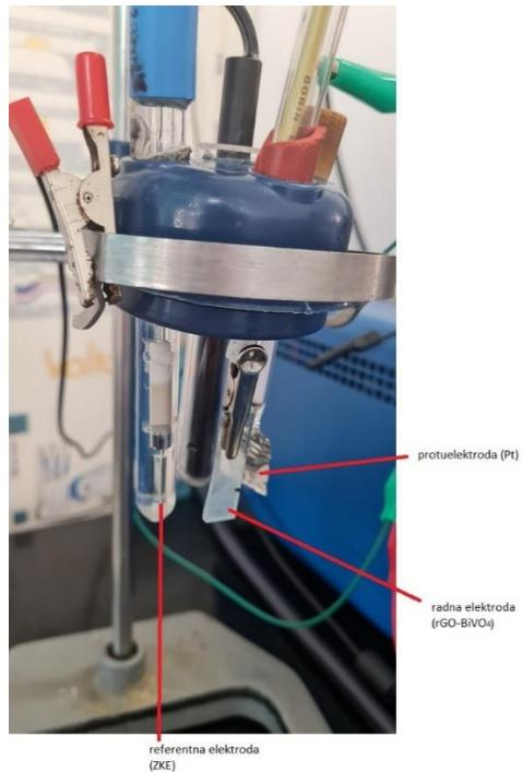
**Slika 3.1.** Troelektrodnji sustav za karakterizaciju elektrode
