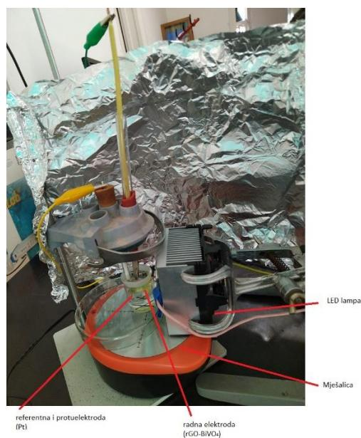
**Slika 3.2.** Dvoelektrodnji sustav za fotokatalizu
