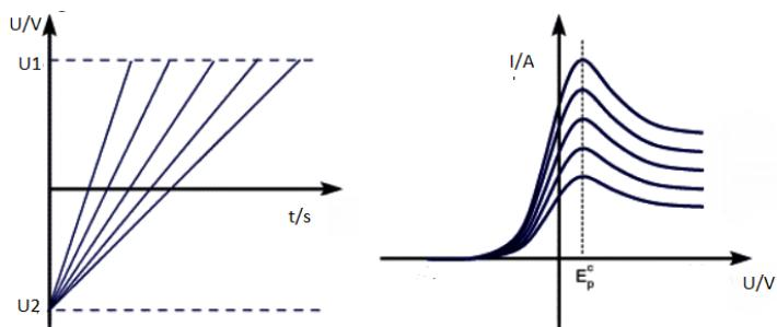
**Slika 2.2.** Prikaz povećanja odziva struje s povećanjem brzine mjerena[12]
