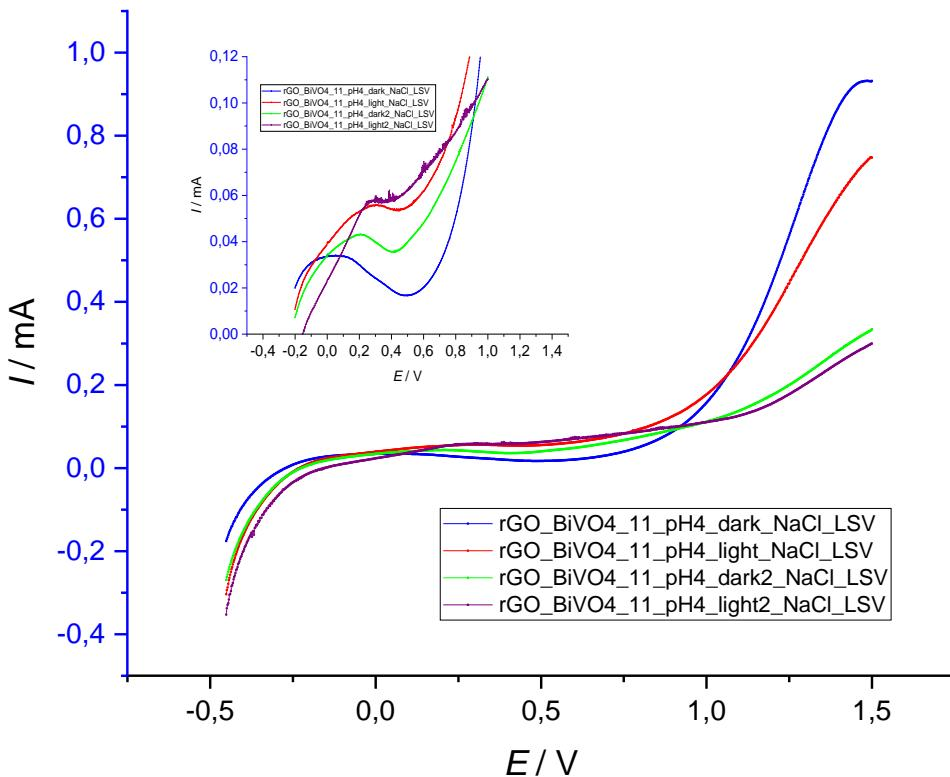
**Slika 4.6.** Voltamogram elektrode 3 zabilježen uz osvjetljenje i bez osvjetljenja u otopini NaCl koncentracije  $0,1 \text{ mol dm}^{-3}$  i pH vrijednosti 4.
