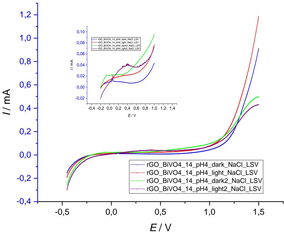
**Slika 4.3.** Voltamogram elektrode 1 zabilježen uz osvjetljenje i bez osvjetljenja u otopini NaCl koncentracije  $0,1 \text{ mol dm}^{-3}$  i pH vrijednosti 4
