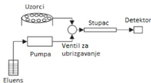
**Slika 2.6.** Shematski prikaz HPLC uređaja
