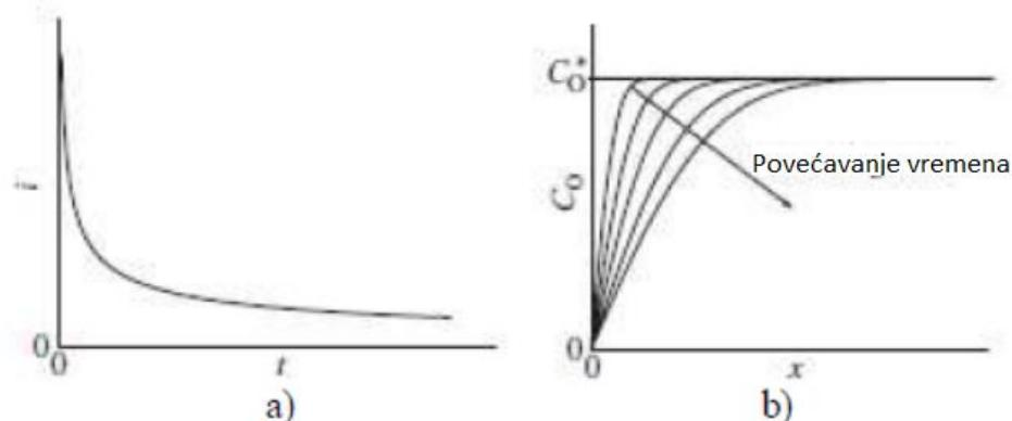
**Slika 2.4.** a) Prikaz ovisnosti struje o vremenu b) koncentracijski profil u ovisnosti o vremenu[13]
