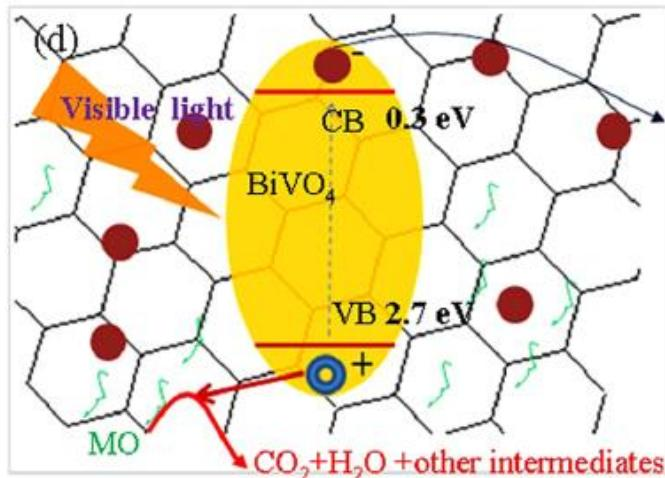
**Slika 5.1.** Shematski dijagram osvijetljene površine rGO\_BiVO<sub>4</sub> u procesu razgradnje metil oranž bojila [28]
