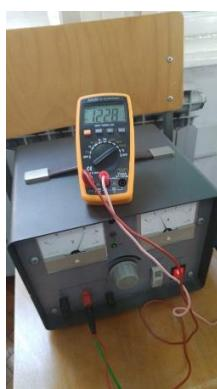
Slika 3.3. Amperometar
