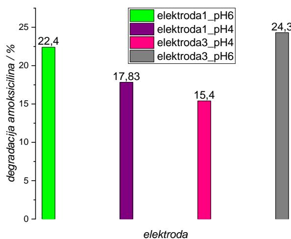
**Slika 5.5.** Grafički prikaz degradacije amoksicilina za elektrode 1 i 3 nakon fotoelektrokemiskog procesa
