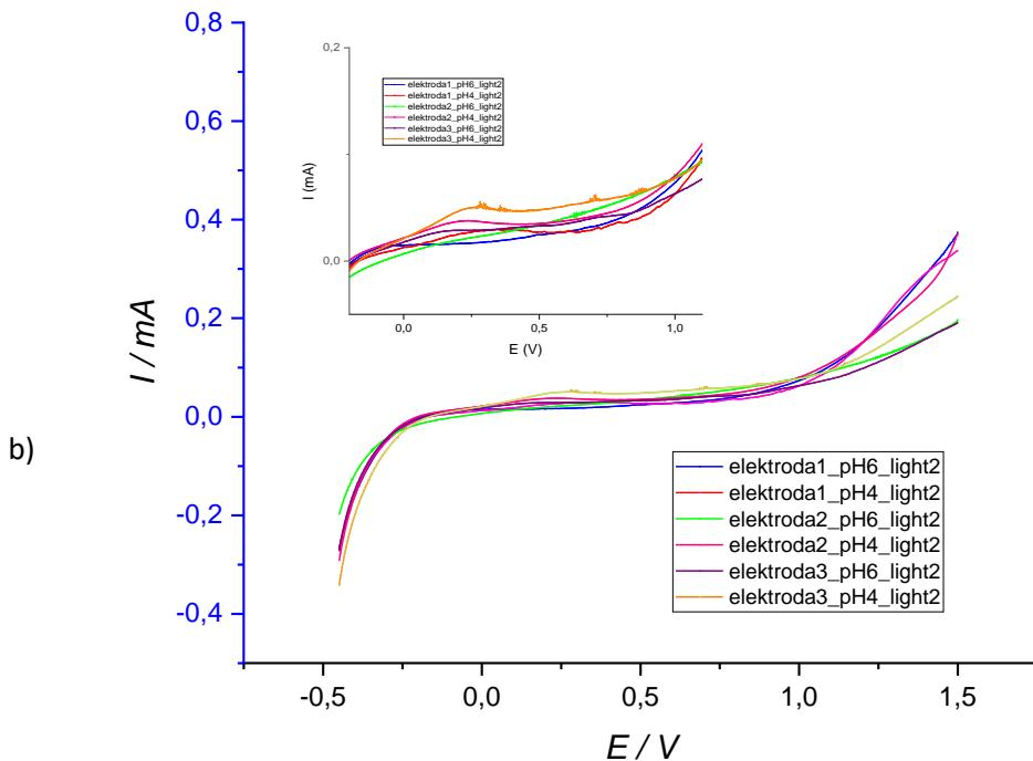
**Slika 5.2.** Voltamogrami osvjetljenih elektroda **a)** prije i **b)** nakon fotoelektrokemijskog procesa
