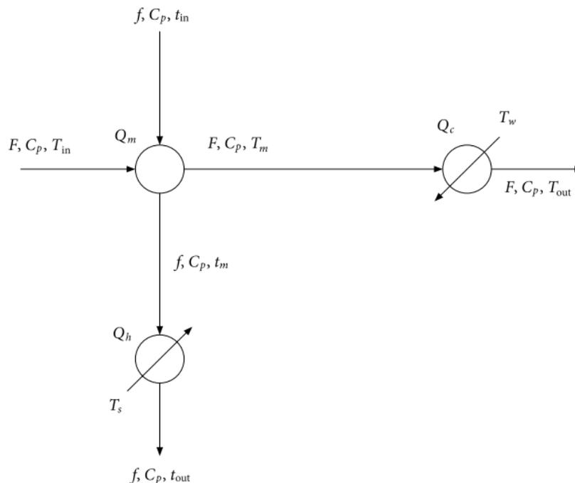
Slika 2.5 Prikaz mreže izmjenjivača topline s tri izmjenjivača topline [1].
