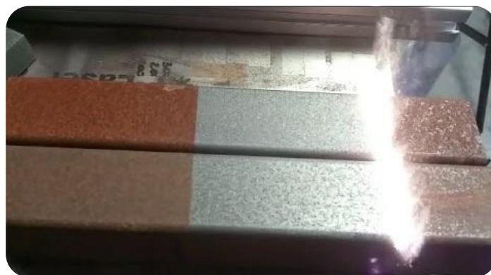
Slika 22. lasersko uklanjanje površinske hrđe s čelika [21]
