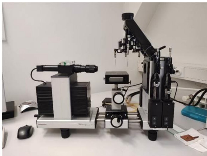
Slika 13. Laboratorijski goniometar DataPhysics OCA20
