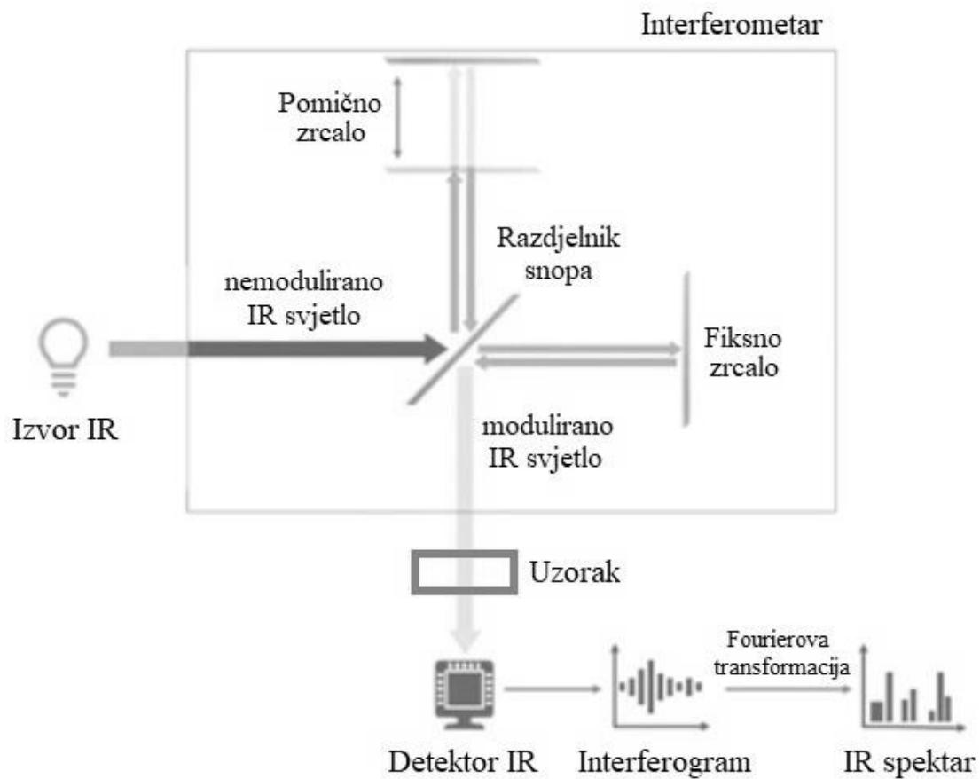
Slika 11. Shematski prikaz interferometra - središnji dio modernih FTIR spektrometara<sup>32</sup>
