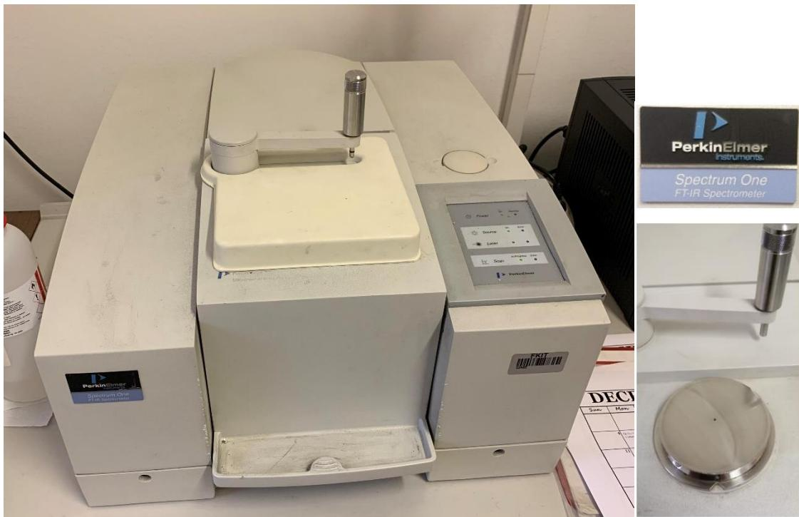
**Slika 21.** Uređaj Perkin Elmer *Spectrum One FT-IR* Spectrometer
