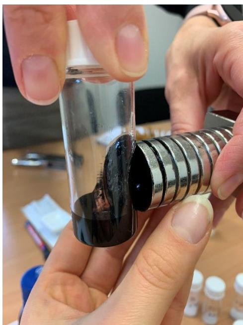
**Slika 20.** Pripremljeni ferofluid korišten u eksperimentalnom dijelu
