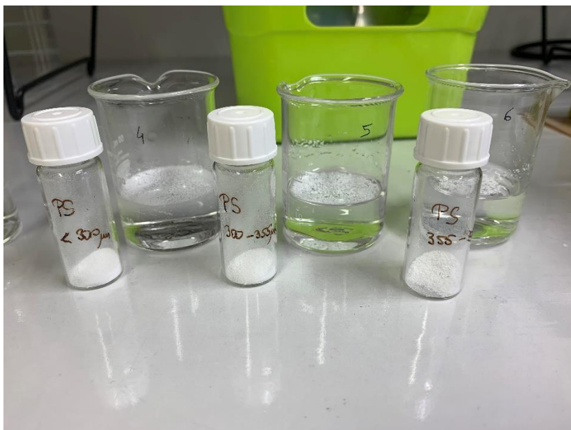
Slika 18. Uzorci mikroplastike PS-a u rasponu od <300 do 500 \mu\text{m} te pripravljene vodene otopine s mikroplastičnim česticama
