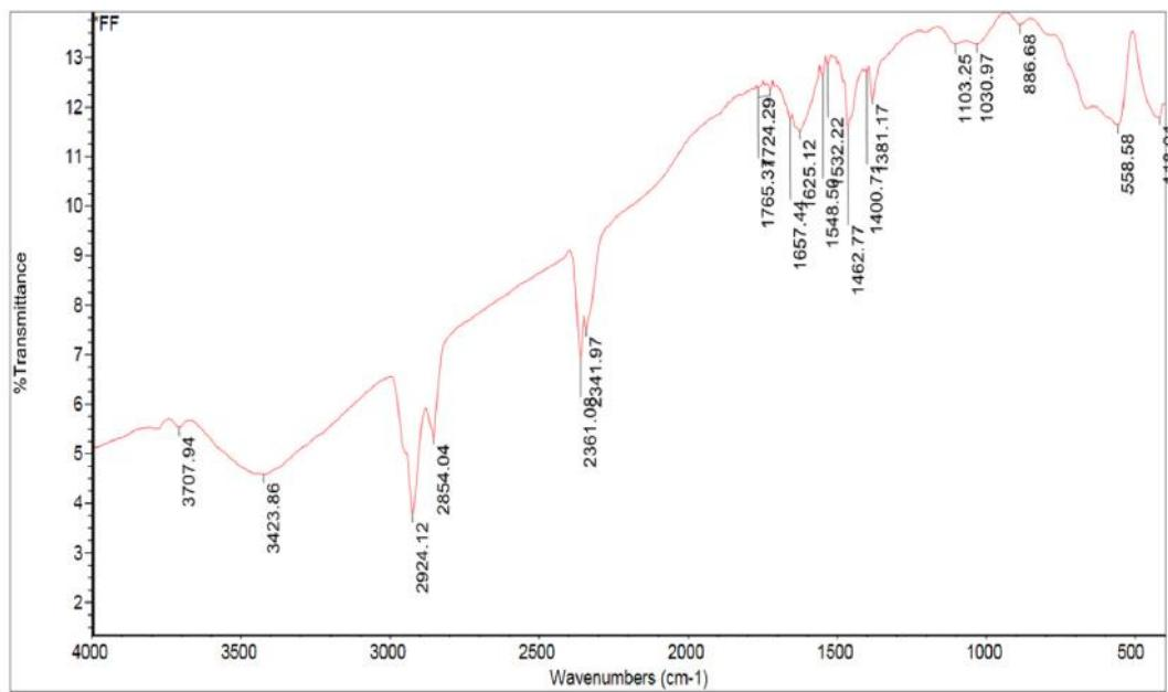
**Slika 10.** FTIR spektar pripremljenih ferofluida<sup>[7]</sup>
