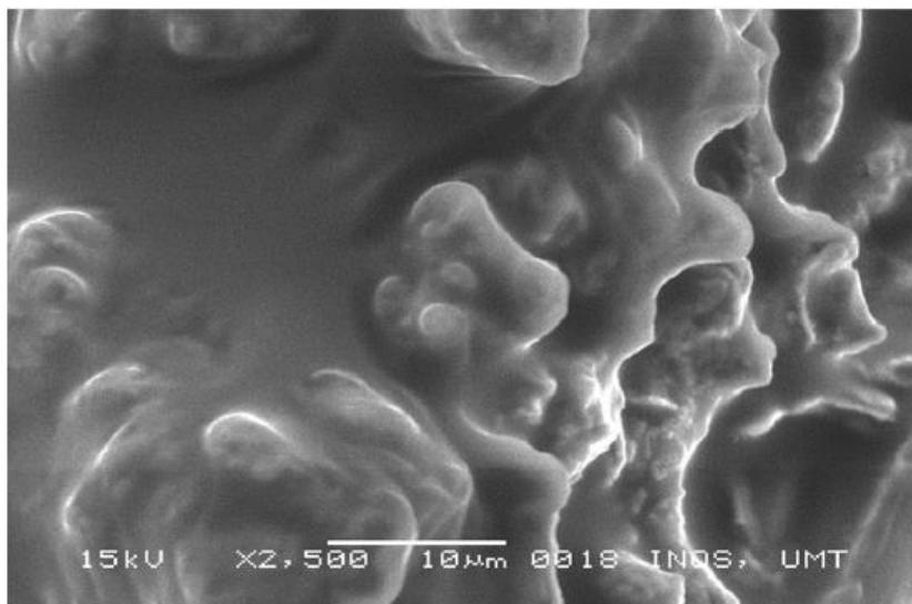
**Slika 9.** SEM slika ferofluida na bazi ulja s povećanjem od 2500 x<sup>[7]</sup>
