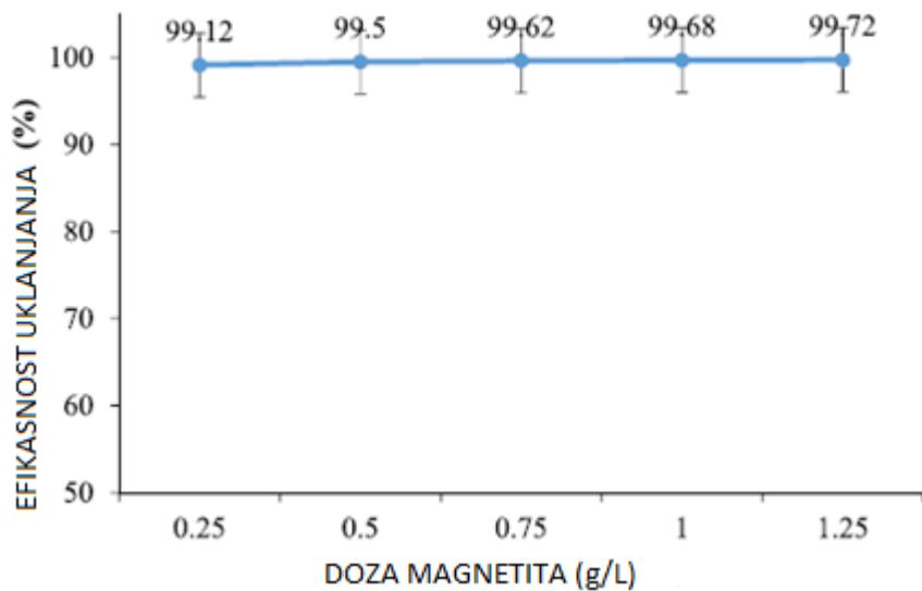
**Slika 14.** Efikasnost uklanjanja mikroplastike u odnosu na različite količine magnetita<sup>[7]</sup>
