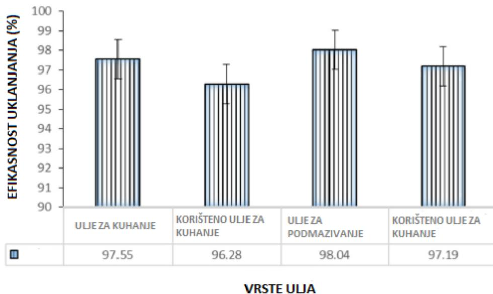
**Slika 12.** Efikasnost uklanjanja mikroplastike korištenjem ferofluida sačinjenog od različitih vrsta ulja (volumen ulja: 2.5 ml, magnetit: 0.5 g/L uzorka)<sup>[7]</sup>
