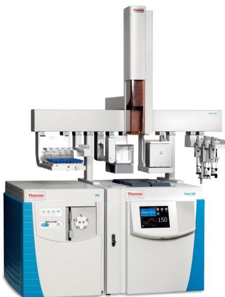
Slika 6. Plinski kromatograf Ultra GC vezan sa spektrometrom masa DSQ II
