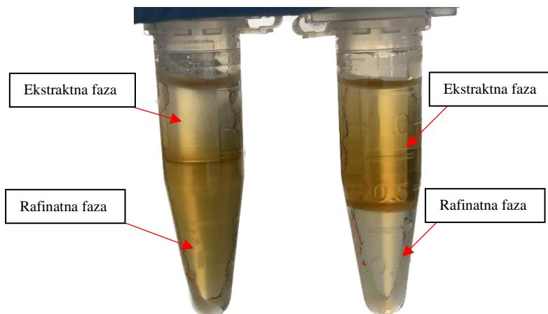
**Slika 32.** Dobiveni uzorci nakon ekstrakcije enzima iz sirovog uzorka enzima dobiven iz *Trametes versicolor* u mikroekstraktoru za različita vremena zadržavanja (lijevo:  $\tau = 0,07$  min, desno:  $\tau = 0,12$  min)
