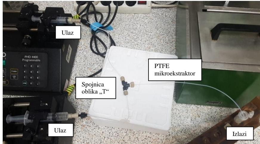
**Slika 18.** Prikaz aparatura za provedbu kontinuirane ekstrakcije enzima lakaza u mikroekstraktoru
