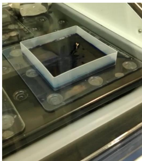
Slika 22. a) Bojanje gela na orbitalnoj tresilici u digestoru, b) odbojavanje gela na orbitalnoj tresilici u digestoru
