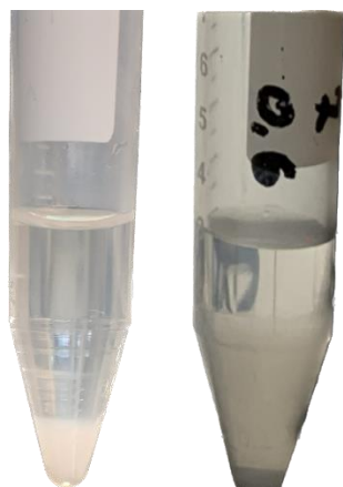
Slika 16. Jednofazni sustav u kojemu nije došlo do odvajanja faza (lijevo) i dvofazni sustav u kojemu je došlo do odvajanja faza (desno) nakon šaržne ekstrakcije
