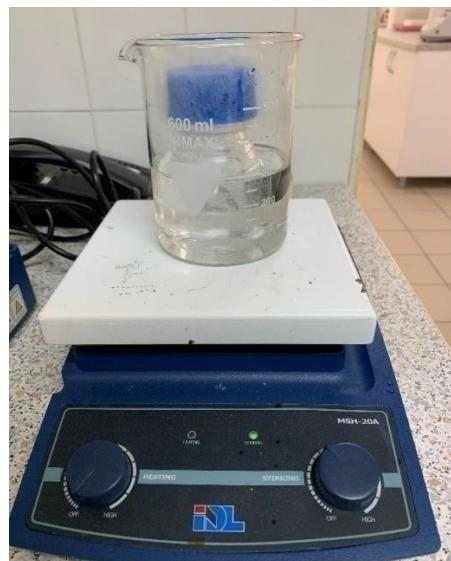
**Slika 14.** Priprema eutektičnog otapala na magnetskoj miješalici i u vodenoj kupelji
