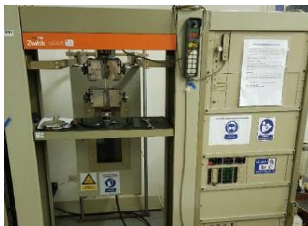
**Slika 16.** Mehanička kidalica Zwick 1445
