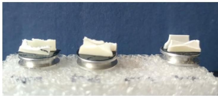
**Slika 17.** Pripremljeni uzroci za SEM analizu
