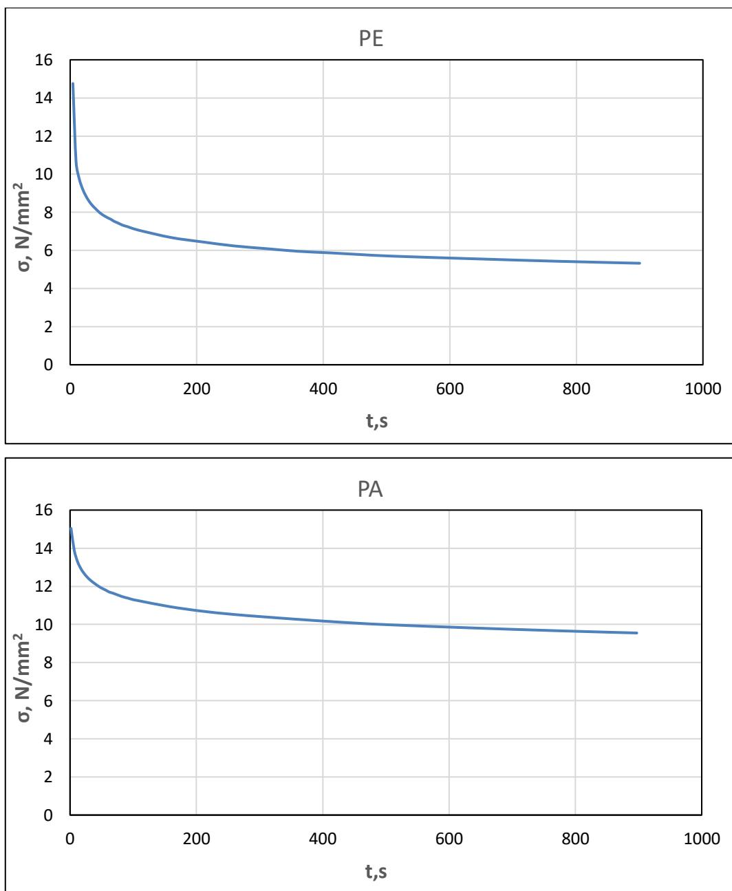
**Slika 26.** Ovisnosti naprezanja u vremenu dobivene testom relaksacije naprezanja za čiste uzorke polietilena i poliamida
