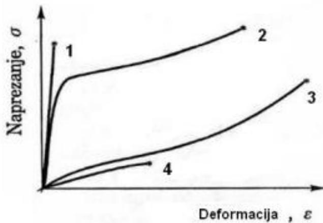
**Slika 2.** Deformacijske krivulje naprezanja-istezanja za karakteristične polimerne materijale
