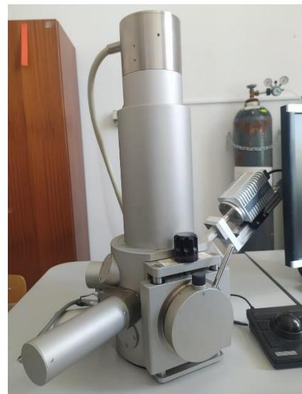
**Slika 18.** Uredaj za naparivanje uzoraka s vodljivim slojem zlata (lijevo), pretražni elektronski mikroskop Tesca Vega serije 3, Bruker (desno)
