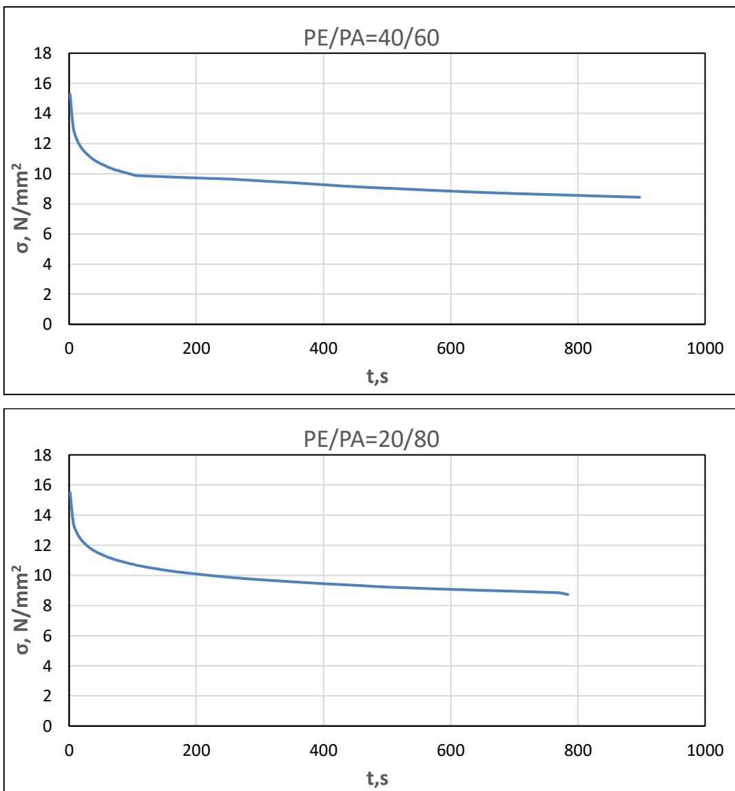
**Slika 27.** Ovisnosti naprezanja u vremenu dobivene testom relaksacije naprezanja za nekompatibilizirane sustave
