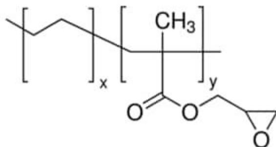
Slika 9. Struktura kompatibilizatora *poli(etilen-ko-glicidil metakrilata)* (PEGMA) [15]
