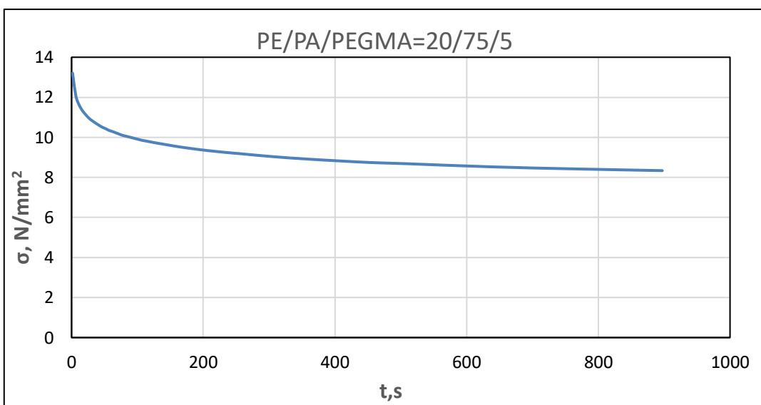
**Slika 28.** Ovisnosti naprezanja u vremenu dobivene testom relaksacije naprezanja za kompatibilizirane sustave
