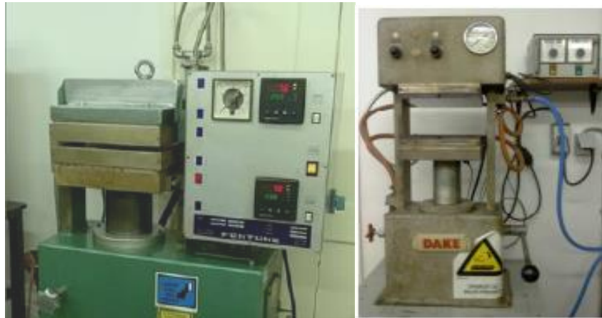
Slika 15. Hidrauličke preše: Fontune (lijevo); Dake (desno)
