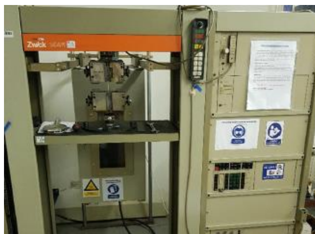
Slika 16. Mehanička kitalica Zwick 1445
