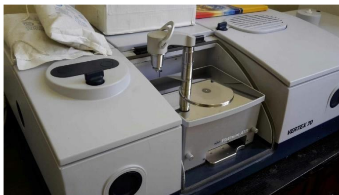
Slika 24. Uređaj za FTIR analizu- Bruker Vertex 70
