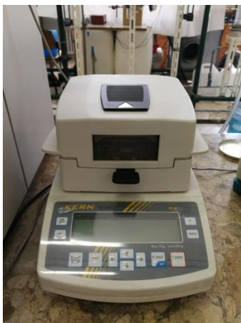
Slika 14. Infracrveni vlagomjer KERN MLS
