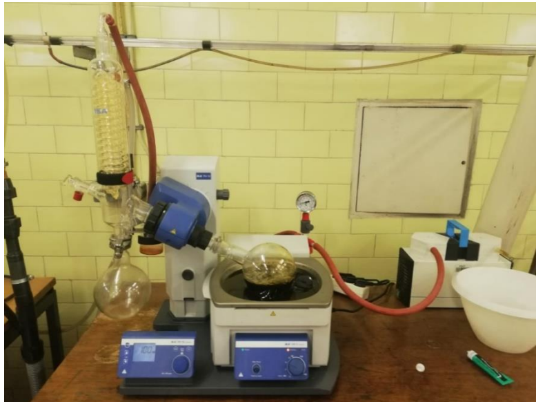
Slika 13. Vakuum isparivač IKA RV 10, rotary evaporator, basic
