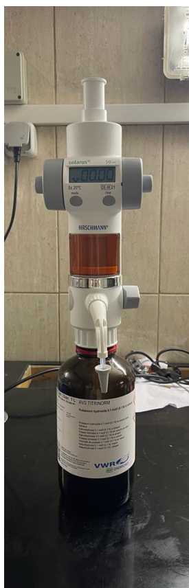
Slika 17. Aparatura za titraciju (poluautomatska bireta)
