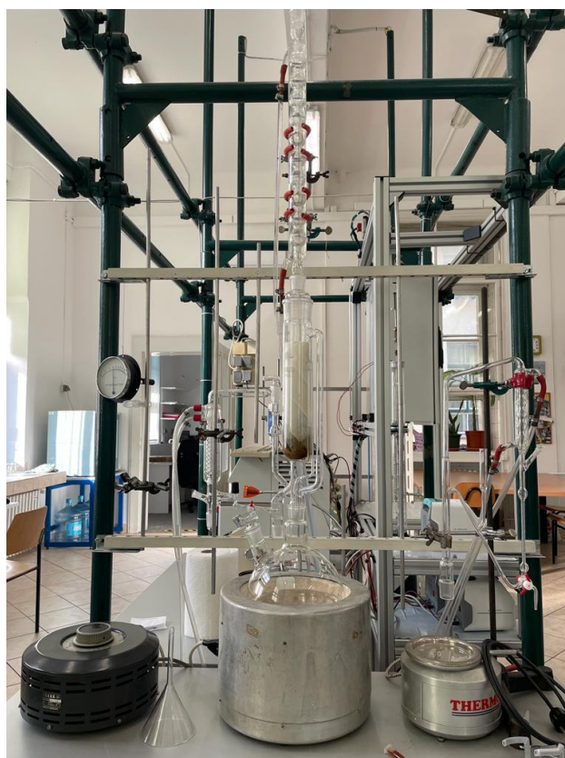
Slika 16. Soxhlet aparatura koja je korištena u laboratoriju
