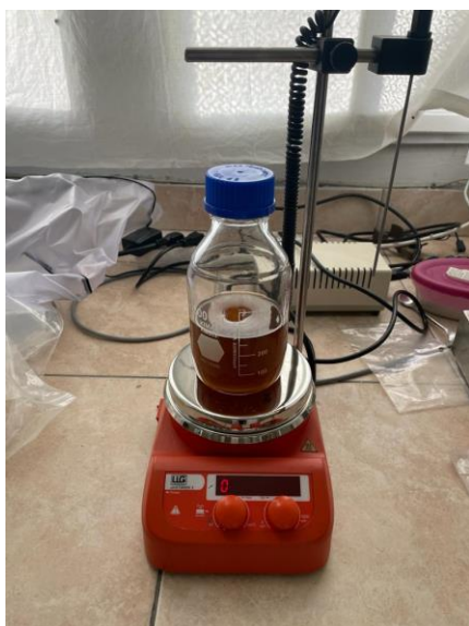
Slika 21. Šaržno pročišćavanje biodizela
