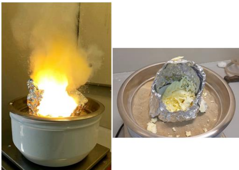
Slika 2. Reakcija sagorijevanja ( lijevo ) i nastali produkt CeO 2 dopiran s 30 mol. % Zr ( desno )
