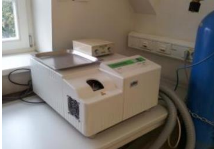
Slika 8. Modulacijski diferencijalni pretražni kalorimetar (MDSC), Mettler Toledo DSC 822 e
