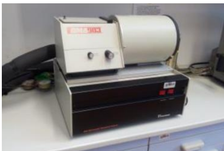
Slika 10. Dinamičko-mehanički analizator (DMA), TA Instruments DMA 983
