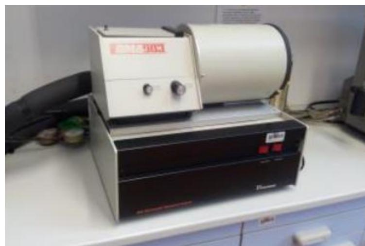
Slika 10. Dinamičko-mehanički analizator (DMA), TA Instruments DMA 983
