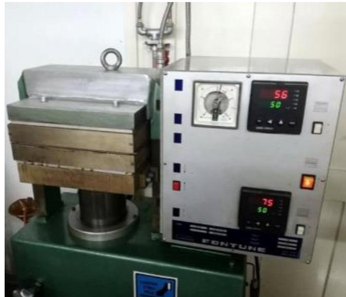
**Slika 7.** Hidraulična preša Fortune Holland
