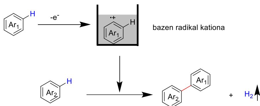
*Shema 4.* Metoda udruživanja radikal kationa za unakrsno-spajanje dva neaktivirana aromatska spoja<sup>23</sup>
