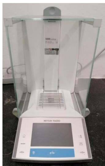
**Slika 26.** Analitička vaga Mettler Toledo XA105 DualRange
