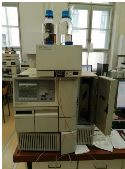
Slika 27. Waters 2795 Alliance HPLC system s 2996 DAD detektorom
