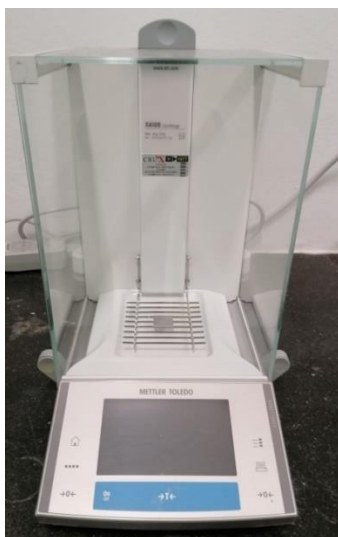
Slika 26. Analitička vaga Metler Toledo XA105 DualRange
