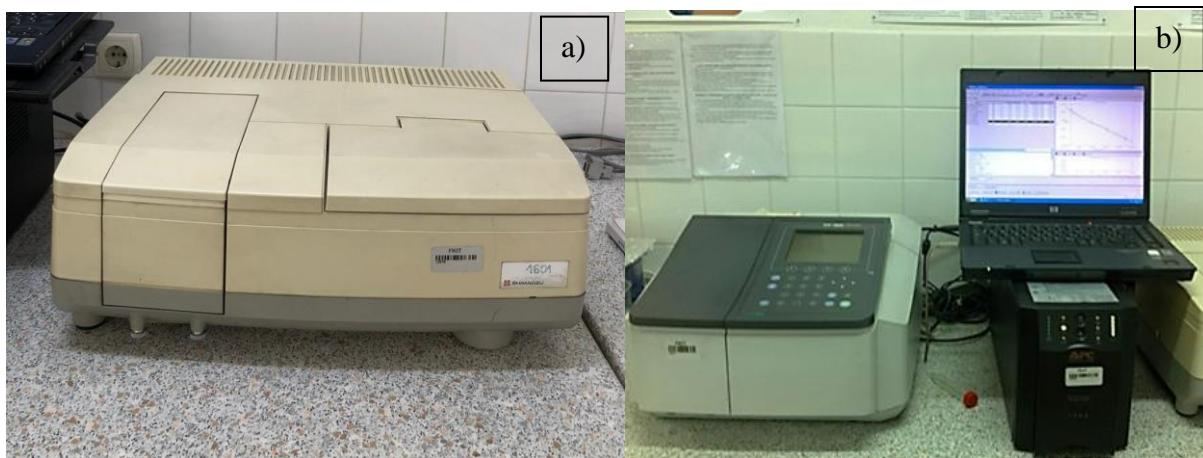
*Slika 3.5. Spektrofotometar Shimadzu a) UV-1601 i b) UV-1800.*
