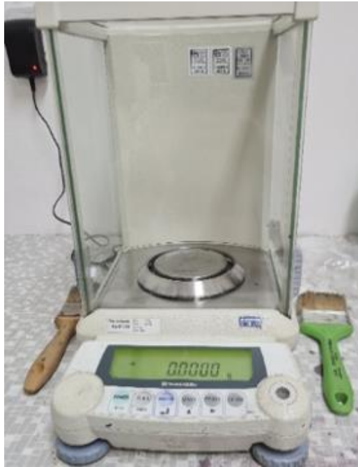
Slika 3.2. Analitička vaga Shimadzu AUW 120.
