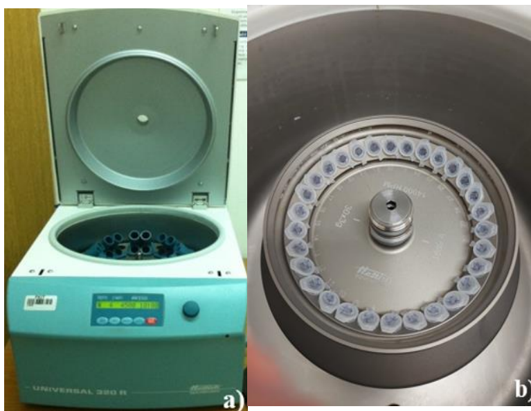
Slika 3.4. a) Centrifuga Hettich Universal 320R i b) rotor.
