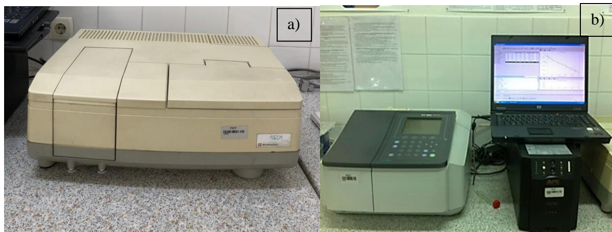
Slika 3.5. Spektrofotometar Shimadzu a) UV-1601 i b) UV-1800.
