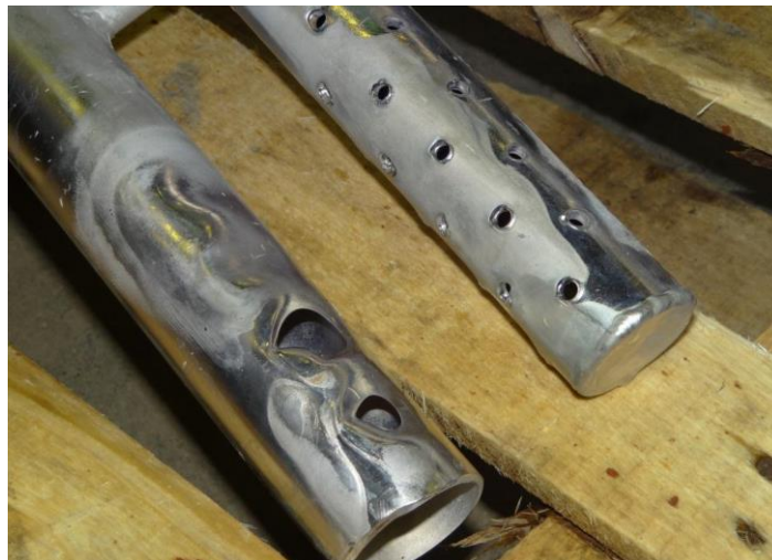
Slika 23. Korozijsko oštećenje vrhova cijevi
