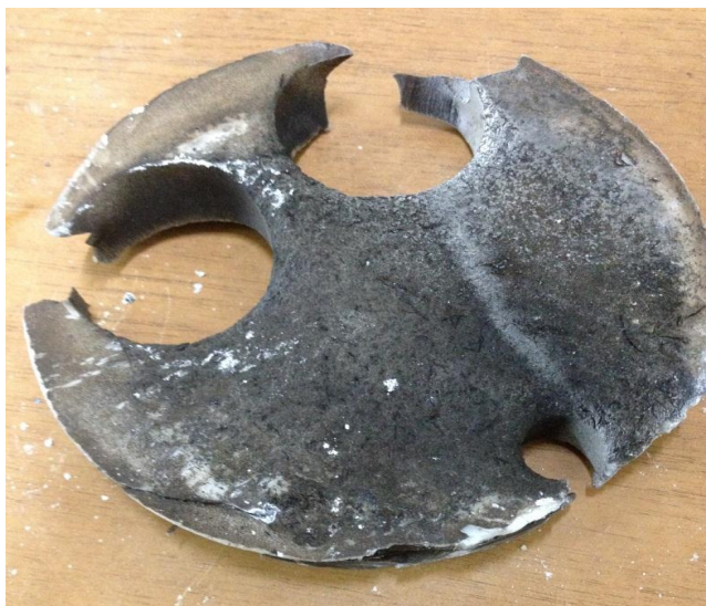
Slika 25. Oštećenja na odlomljenoj pregradi u reaktoru
