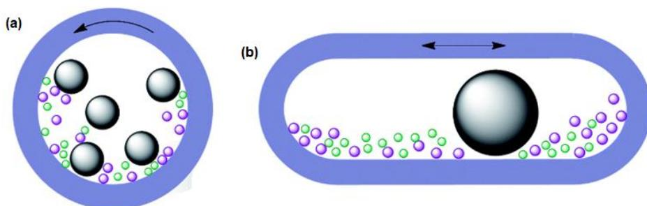
Slika 6. Shematski prikazi načina mehaničke aktivacije kemijskih reakcija: a) planetarno kuglično mljevenje; b) vibracijsko mljevenje velike brzine<sup>20</sup>
