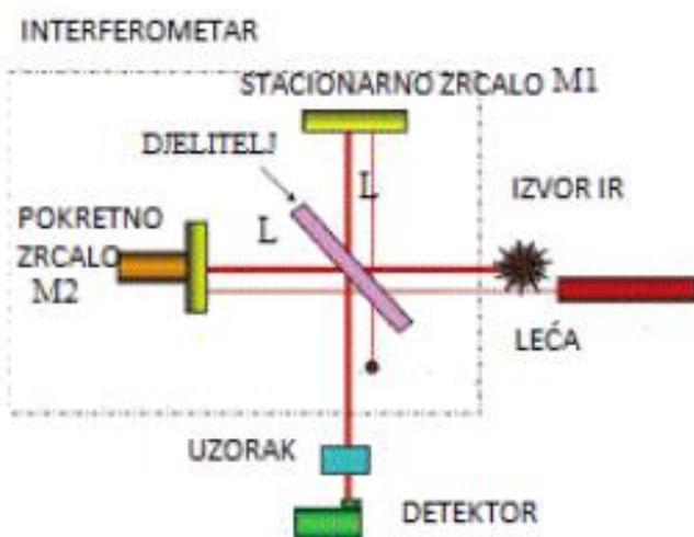
Slika 5. Konstrukcija FTIR spektrometra
