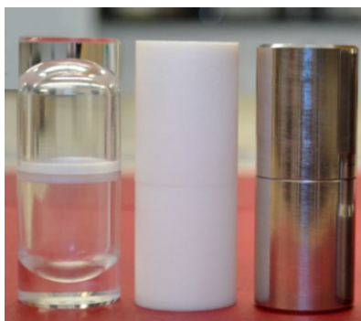
Slika 5. Posudice za mlin od različitih materijala (s lijeva na desno): poli(metil-metakrilat), teflon i nehrđajući čelik 1
