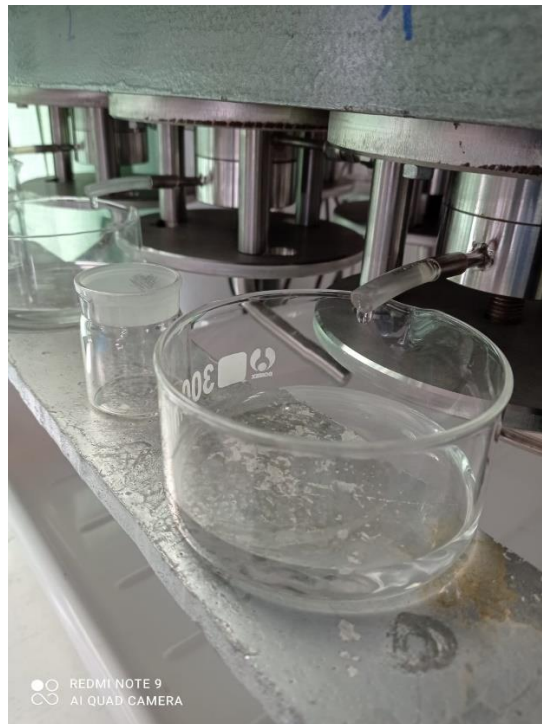
Slika 14. Stabilizacija protoka deionizirane vode u RO uređaju
