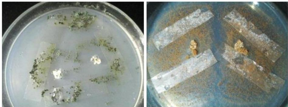
**Slika 15.** Test biorazgradnje LDPE sa odabranim kulturama nakon 45 dana inkubacije,
