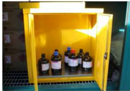
Unutrašnjost sigurnosnog ormarića za zapaljive tvari
