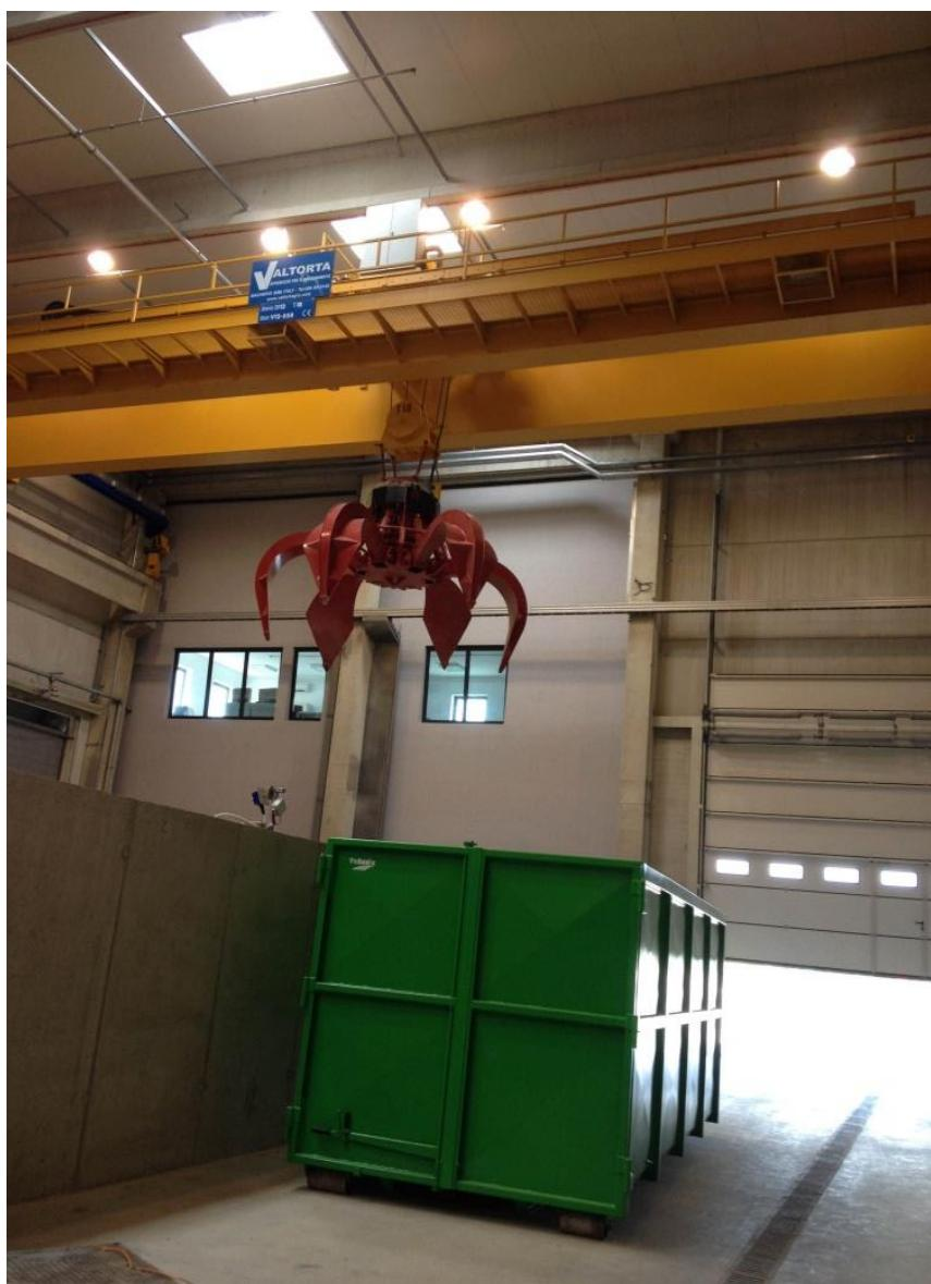
**Slika 27.** Prikaz automatski upravljanog krana za prijenos otpada do dijela postrojenja za predobradu otpada
