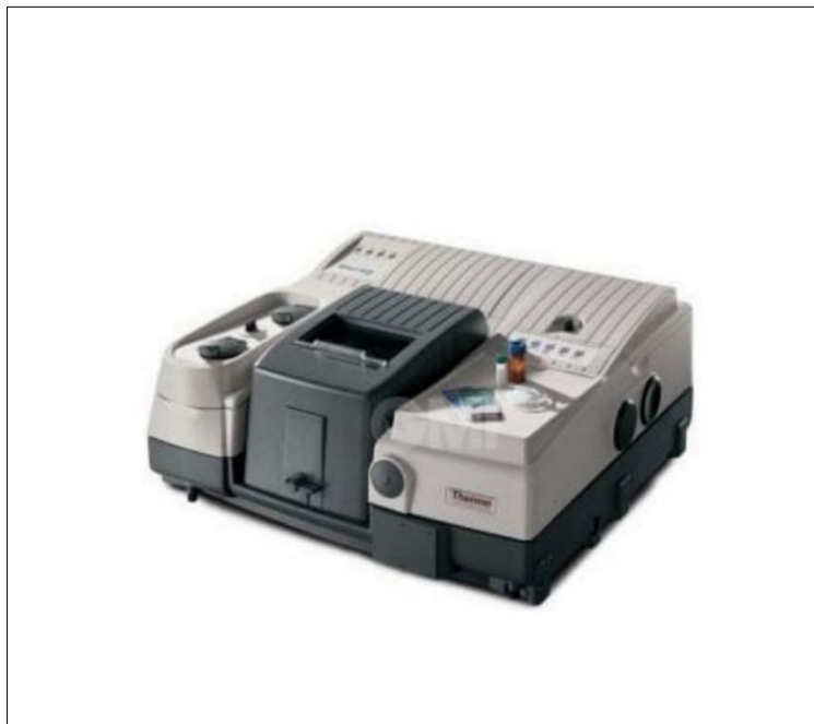
Slika 2.19. Infracrveni spektrometar Nicolet-Nexus 670
