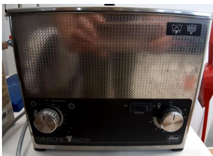
Slika 7. Ultrazvučna kupelj Elma Transsonic, 460H.
