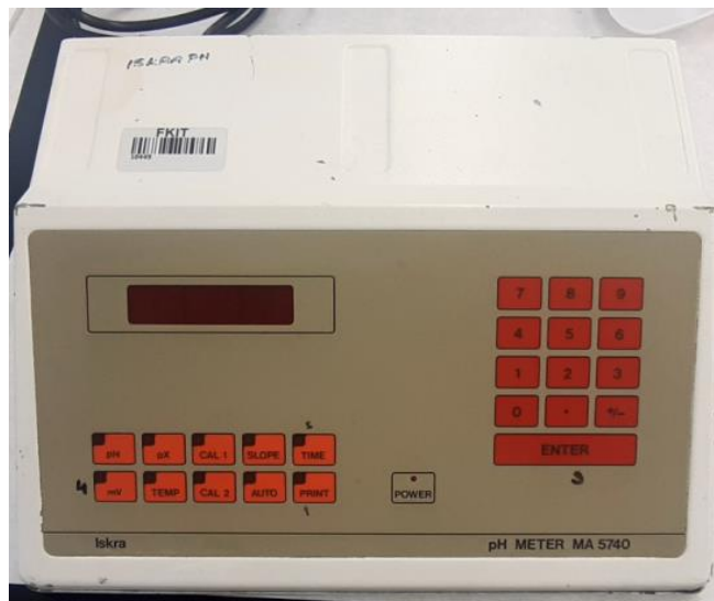
Slika 8. pH metar Iskra MA 5740.
