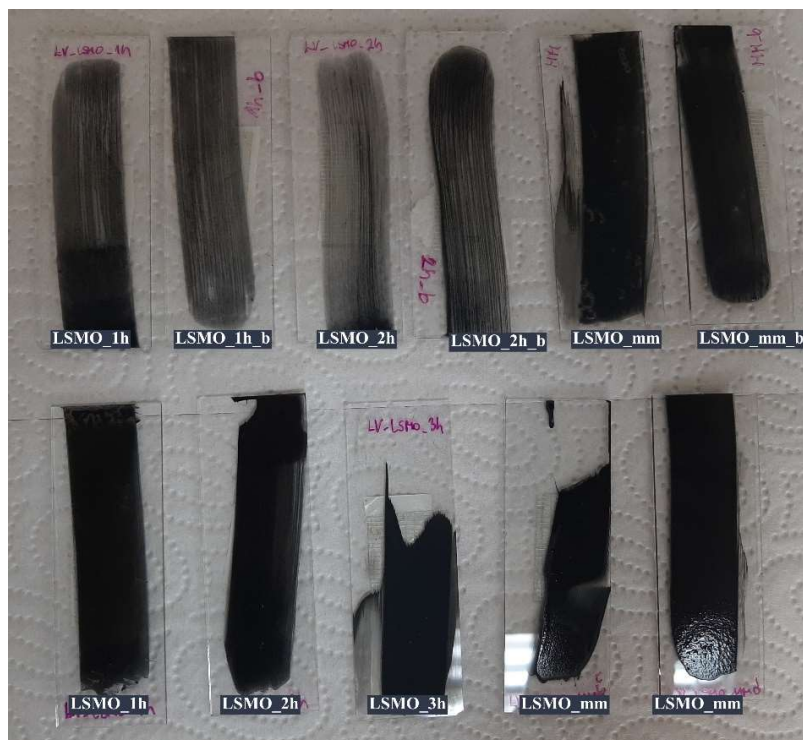
Slika 4. Prevlake nanosjene na predmetna stakalca. U prvom redu prikazane su prevlake dobivene iz paste pripremljene u plastičnoj kiveti uz 3 ili 5 kapi PVDF-a (oznaka b = 5 kapi). U drugom redu prikazane su prevlake dobivene iz paste pripremljene u ahatnom tarioniku uz dodatak 5 kapi PVDF-a.
