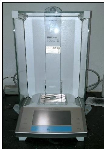
*Slika 5. Analitička vaga proizvođača Mettler Toledo XA105 DualRange.*
