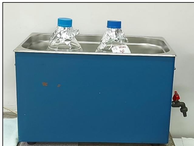
*Slika 8. Ultrazvučna kada proizvođača Iskra.*
