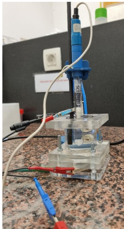
Slika 12. Troelektrodna elektrokemijska ćelija sa tekućim elektrolitom
