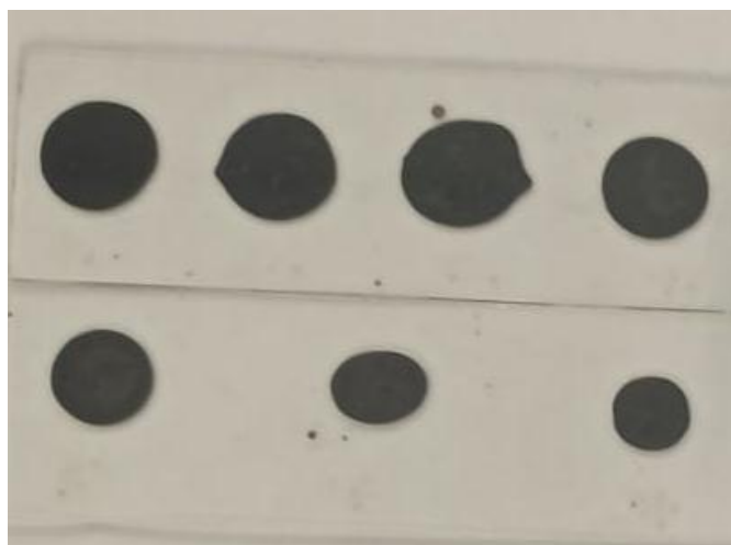
Slika 51. Tanki filmovi na staklu nakon sušenja u peći za žarenje.
