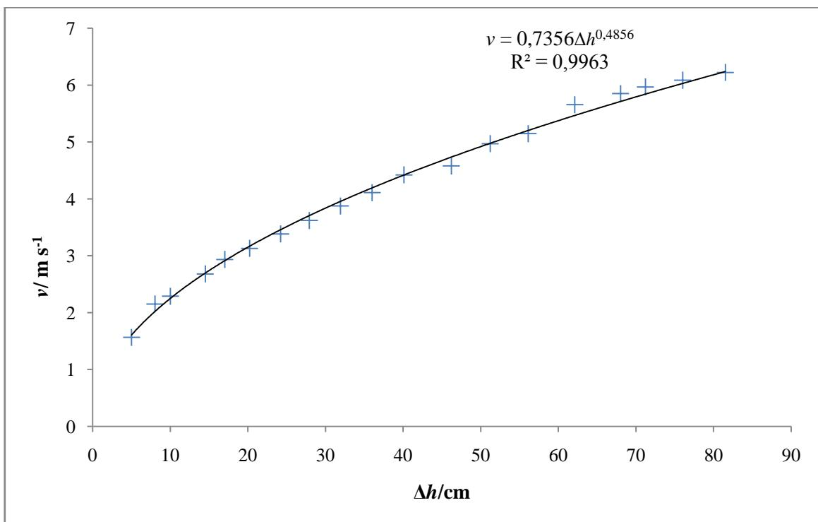
Slika 48. Baždarni dijagram prigušne pločice za manji sušionik
