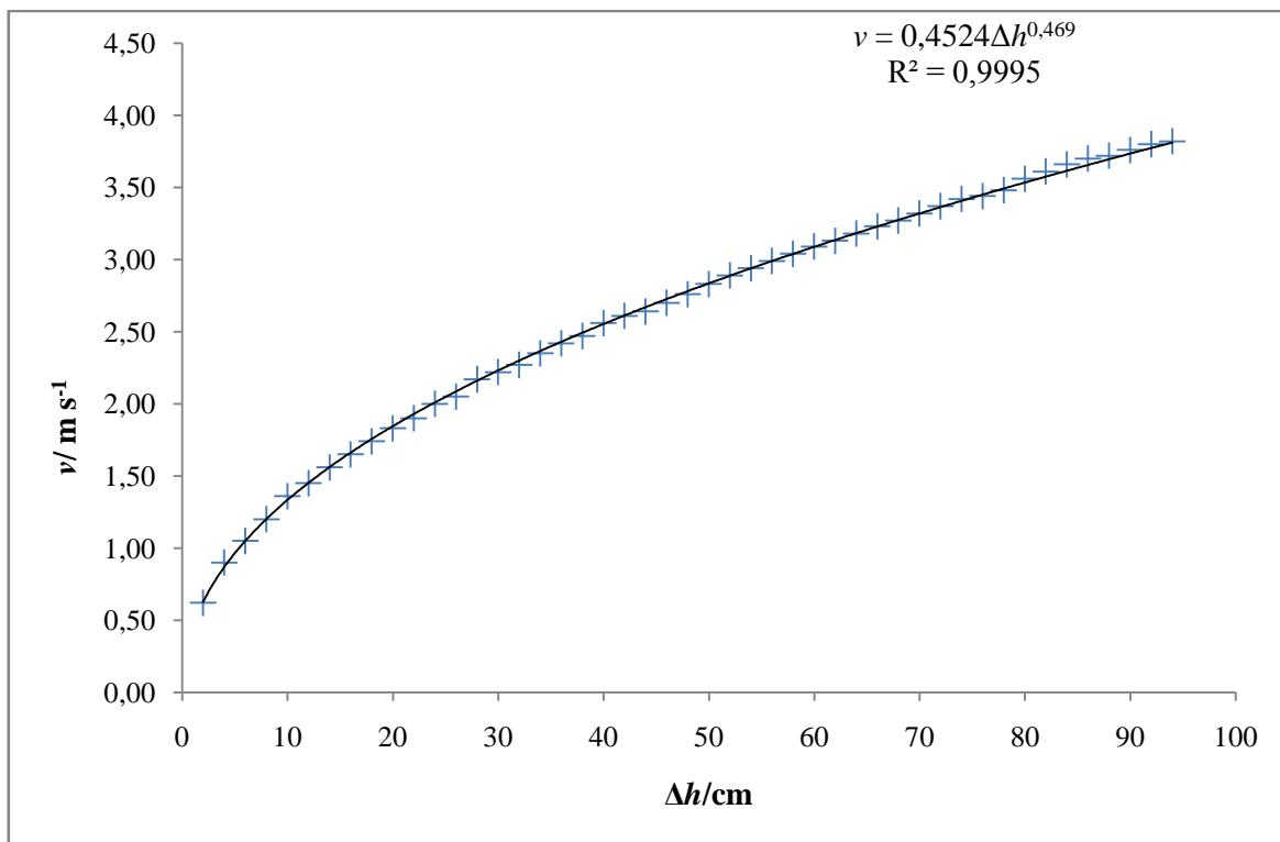
Slika 47. Baždarni dijagram prigušne pločice za veći sušionik
