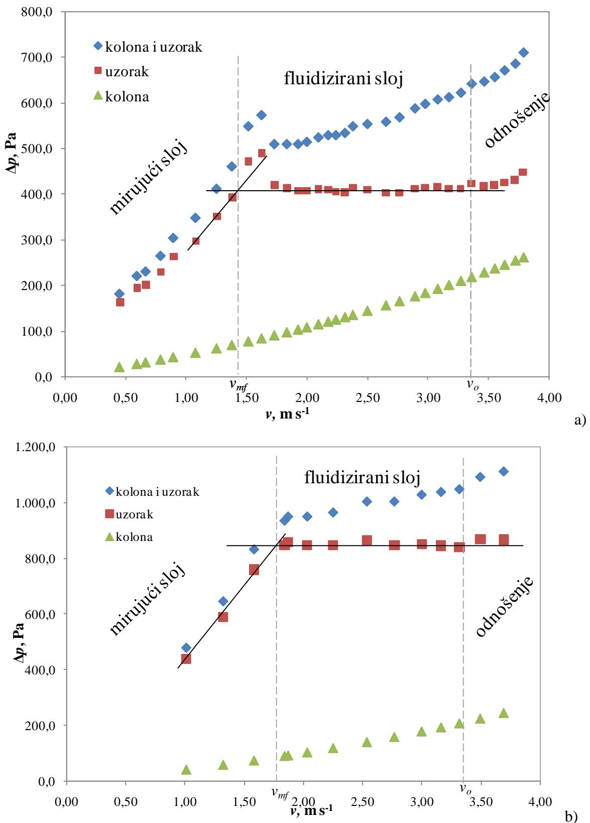
**Slika 26.** Eksperimentalno određivanje minimalne brzine fluidizacije:
