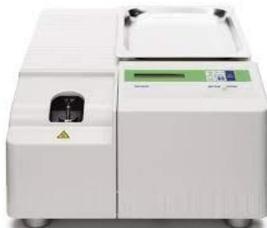
Slika 3.3.2.1. Diferencijalni pretražni kalorimetar, Mettler Toledo DSC 823e
