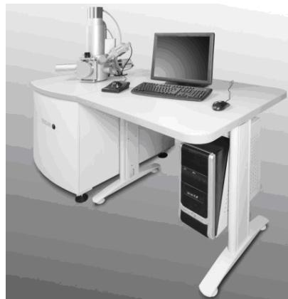
**Slika 3.3.3.1.** Pretražni elektronski mikroskop (SEM), Tecan VEGA 3
