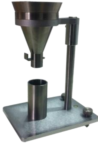
Slika 10. Aparatura za mjerenje volumne mase cementa 34
