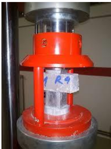
Slika 8. Hidraulična preša i uzorak betona 33
