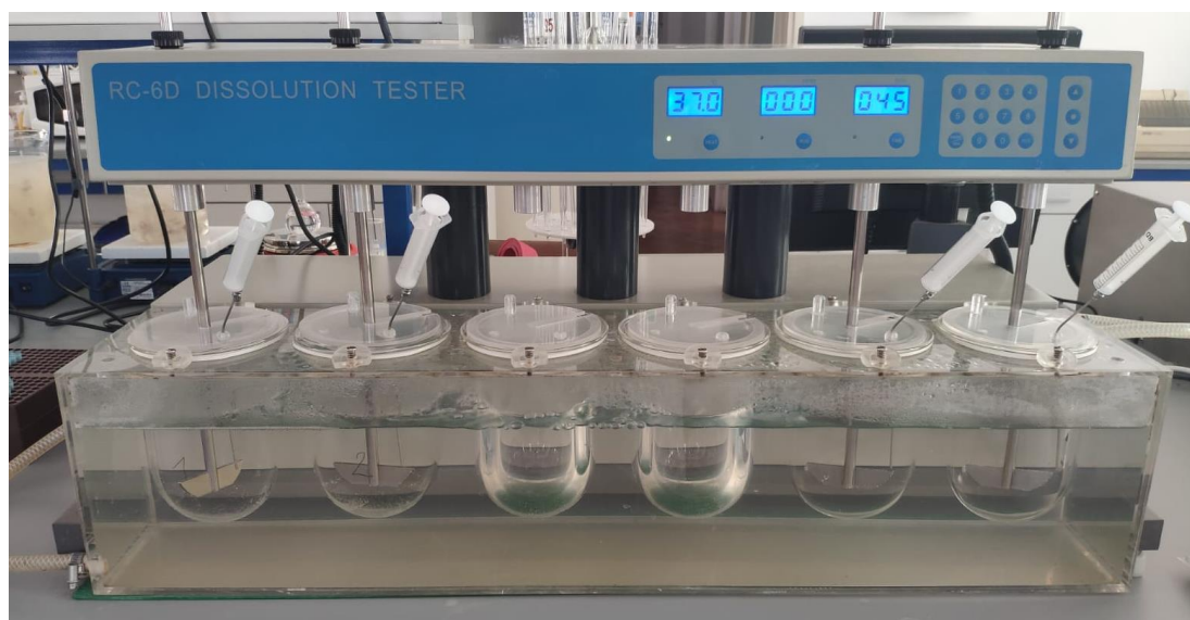
Slika 17. Uređaj za ispitivanje oslobađanja djelatnih tvari
