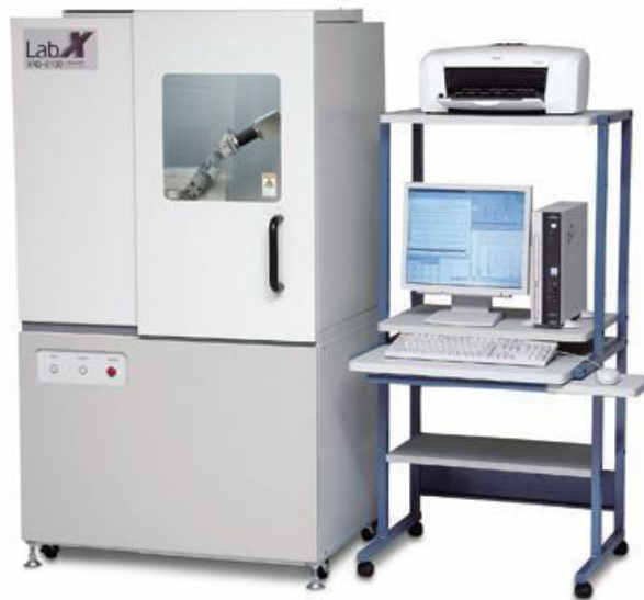
Slika 18. Fotografija difraktometra Shimadzu XRD 6000 (Shimadzu, Kyoto, Japan)
