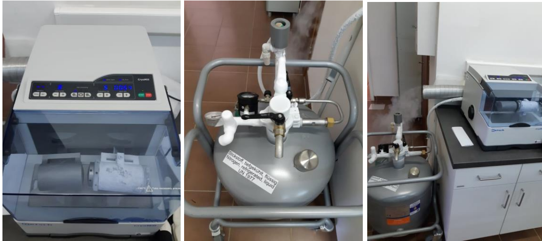
Slika 3.5. Kriomlin s tekućim dušikom kao radnim plinom korišten za dobivanje MP
