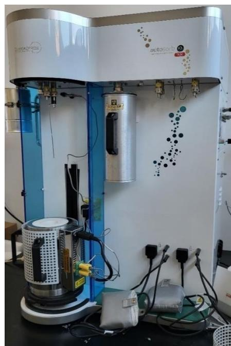
Slika 33. Quantachrome Autosorb uređaj za mjerjenje specifične površine i poroznosti
