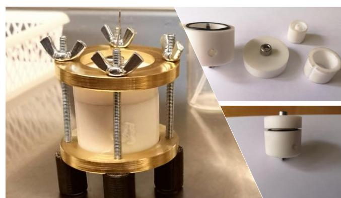
Slika 26. Dvoelektrodna čelija za elektrokemijska ispitivanja dizajnirana u Laboratoriju za molekulsku fiziku i sinteze novih materijala, Institut Ruđer Bošković
