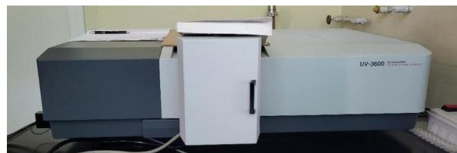
Slika 32. Shimadzu UV/VIS/NIR spektrometar, model UV-3600 dostupan u Zavodu za kemiju materijala, Institut Ruđer Bošković
