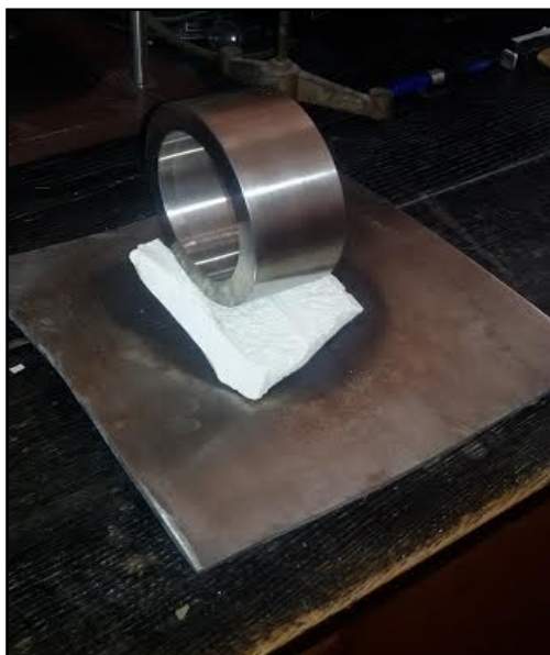
Slika 3.4. Ručno drobljenje uzoraka u laboratoriju
